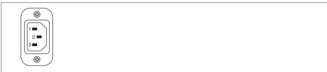
Abbildung 3.5 Einbauadapter C14 1 und 3 = Wechselstrom 2 = Masse
