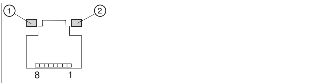
Abbildung 3.12 Neben dem LAN-Port befinden sich zwei LEDs. Die grüne LED ① ist die ACT/LINK-LED. Die gelbe LED ② ist die Geschwindigkeits-LED. Die Bedeutung der LED-Anzeigen für den LAN-Port entnehmen Sie der nachfolgenden Tabelle "LED-Anzeige".
