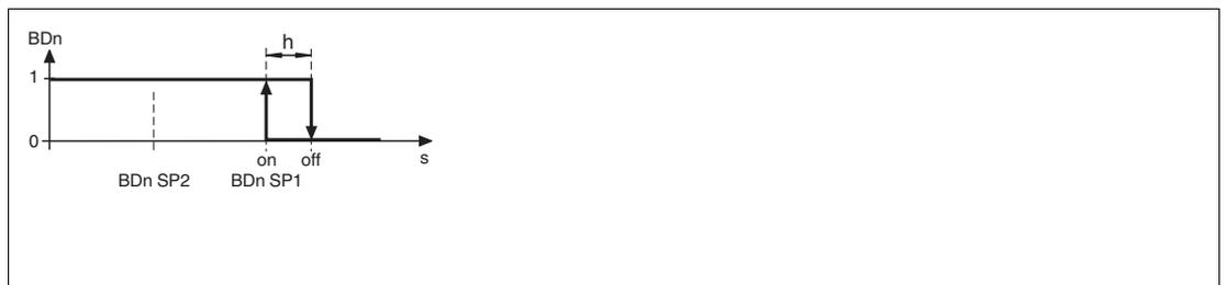
Der Ausgang schaltet, wenn der Positionswert kleiner als SP1 ist. Ein evtl. in SP2 eingestellter Wert wird ignoriert.
