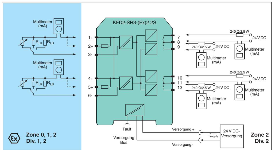
Abbildung 5.1 Aufbau Wiederholungsprüfung für KFD2-SR3-(Ex)2.2S
