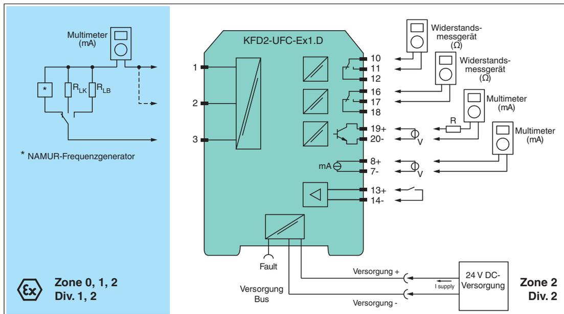
Abbildung 5.1 Aufbau Wiederholungsprüfung für KF\*\*-UFC-(Ex)1.D
