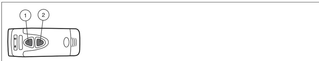
Abbildung 4.2 Trigger-Tasten
