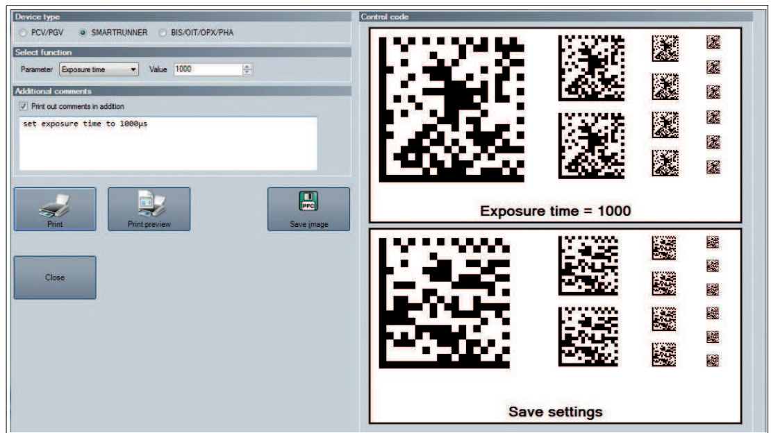
Abbildung 6.19 Steuercode erzeugen: Belichtungszeit 1000 µs
