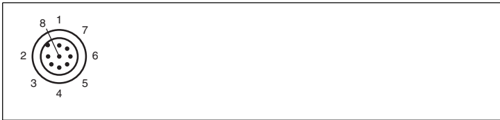
Abbildung 5.1 Anschlussbelegung Betriebsspannung und Eingänge und Ausgänge
