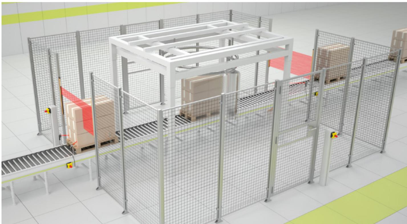
Zutrittsabsicherung an Folienwicklern mit der SafeBox und diversen Schutzeinrichtungen
