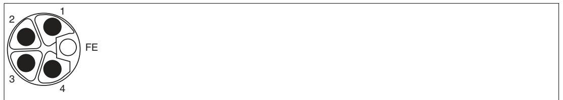
Abbildung 2.3 Schemazeichnung M12 L-Codierung (Stecker); Port X03 (IN)
