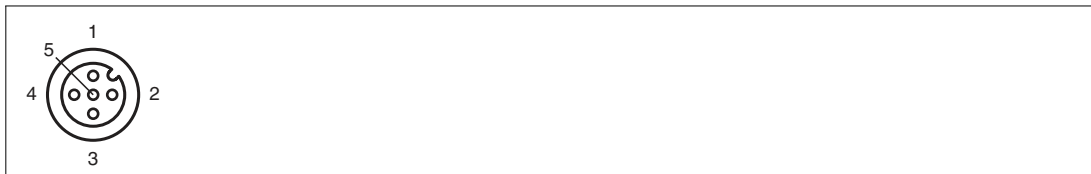
Abbildung 2.5 Schemazeichnung M12-Buchse, 5-polig, A-kodiert, Port X1 ... X8
