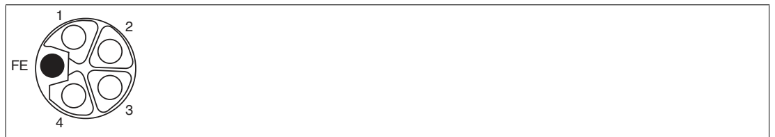
Abbildung 2.4 Schemazeichnung M12 L-Codierung (Buchse); Port X04 (OUT)
