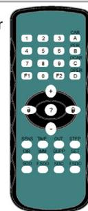
Gli intervalli di parametri separati vengono memorizzati nel sensore radar per ciascuno dei tre metodi di regolazione disponibili (telecomando RMS, tasti, telecomando RADAR-RC). Di conseguenza, le regolazioni eseguite con i tasti non vengono perse quando il telecomando viene selezionato utilizzando nel frattempo DIP 6 e le letture effettuate utilizzando i tasti non possono essere lette utilizzando un telecomando.
