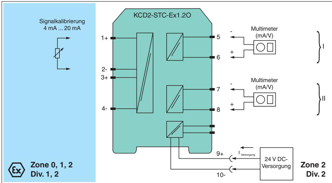
Abbildung 5.2 Aufbau Wiederholungsprüfung für KCD2-STC-(Ex)1.20.\*\*
