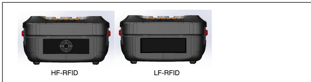
Abbildung 3.4 Position RFID Reader
