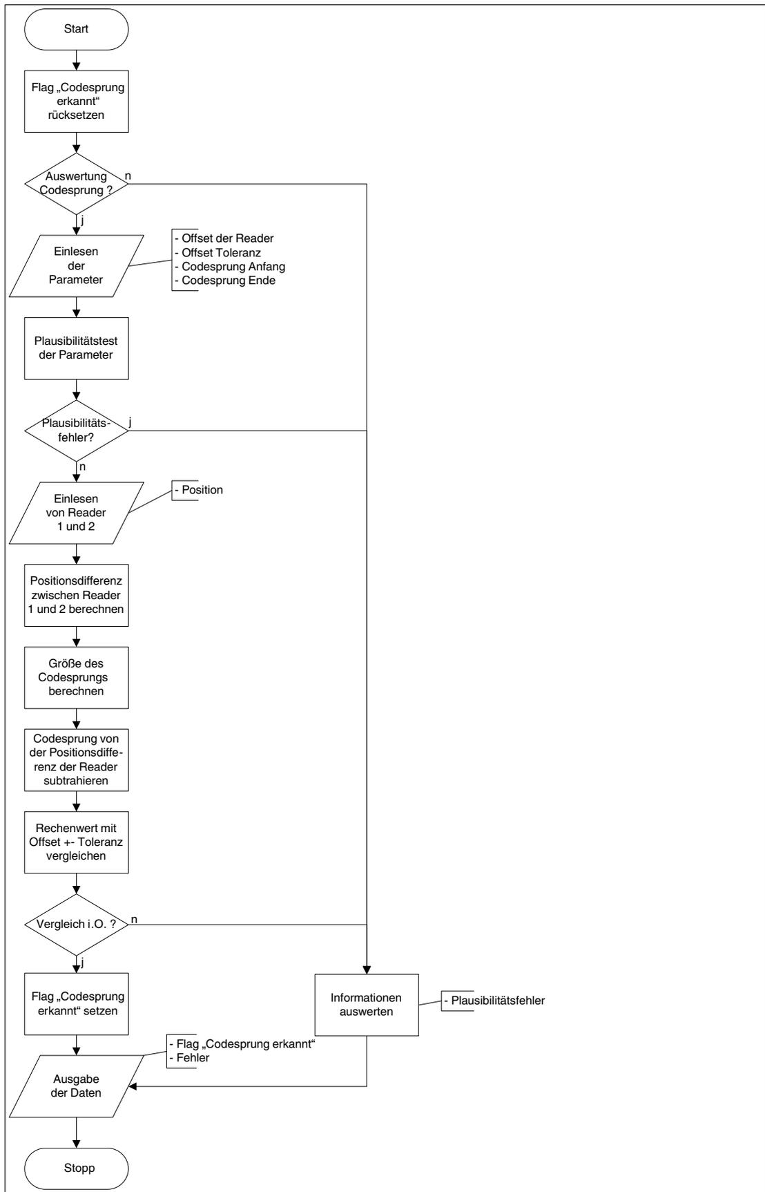
Abbildung 4.2 Blockschaftbild zur sicheren Reaktion auf Codesprünge
