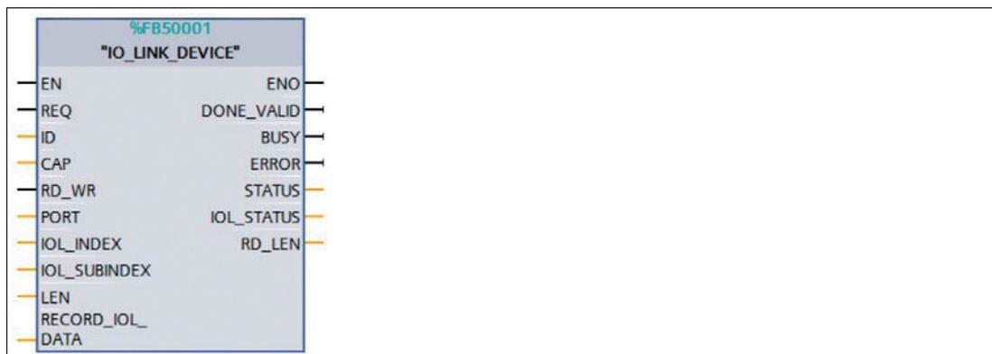
Abbildung 6.24 TIA Portal IO\_LINK\_DEVICE
