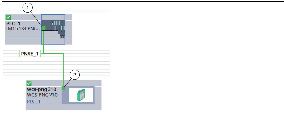
Abbildung 4.9 Interface-Modul mit Steuerung verbinden
