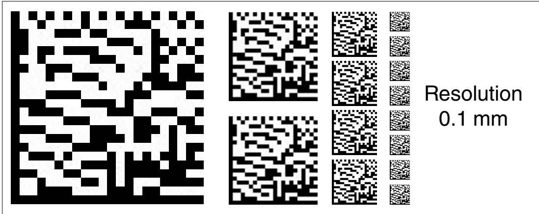
Abbildung 6.6 Die Codekarte weist dem Lesekopf eine Auflösung der Positionsdaten von 0,1 mm zu.
