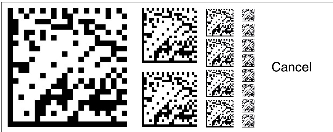
Abbildung 6.3 Die Codekarte "CANCEL" verwirft die vorgenommene Parametrierung und beendet die Betriebsart für externe Parametrierung. Der Lesekopf geht in den Normalbetrieb unter Benutzung der zuletzt gültig gespeicherten Konfiguration.
