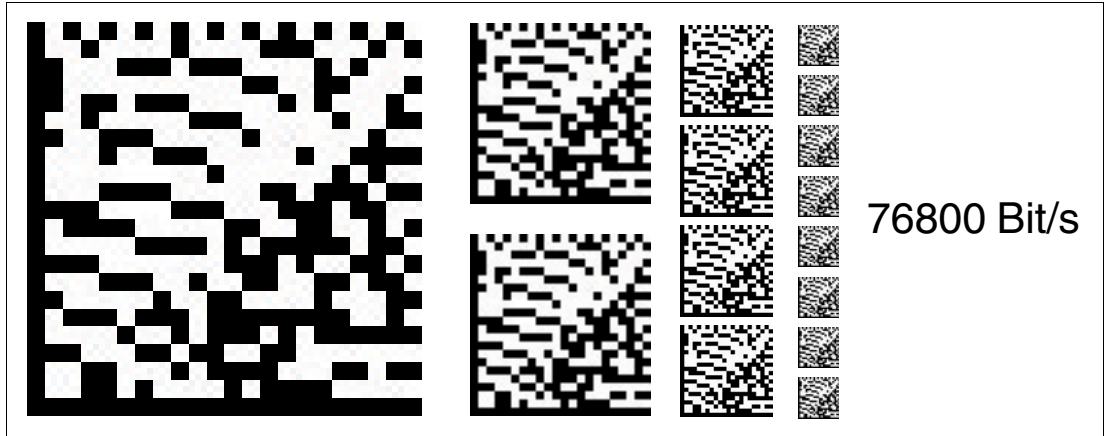
Abbildung 6.18 Die Übertragungsrate des Lesekopfs für die Kommunikation über die Schnittstelle wird auf 76800 Bit/s eingestellt.
