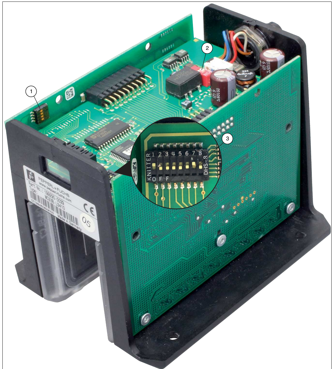
Abbildung 6.2 Positionen der Konfigurationsschalter
