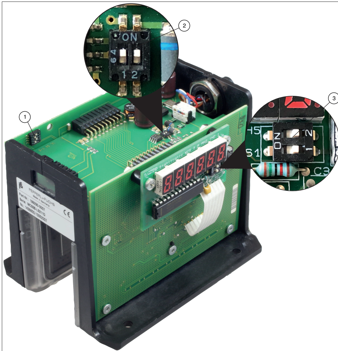
Abbildung 4.3 Positionen der DIP-Schalter
