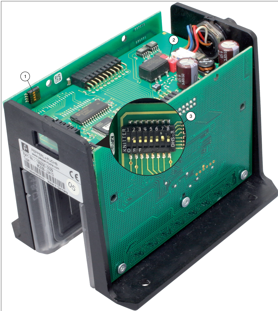
Abbildung 6.2 Positionen der Konfigurationsschalter
