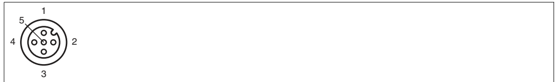
Abbildung 2.2 Schemazeichnung Port X1 bis X8
