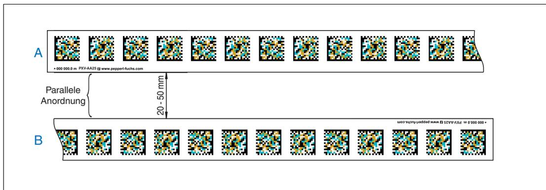
Abbildung 6.15 Prinzipdarstellung: Leseverhalten beim Spurwechsel zwischen 2 parallel verlaufenden DataMatrix-Codebändern. Möglicher Abstand zwischen den DataMatrix-Codebändern: 20 mm ... 50 mm
