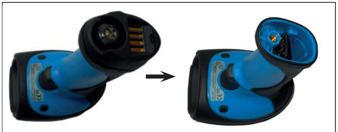
Abbildung 5. Entfernen des Akkufach-Deckels
