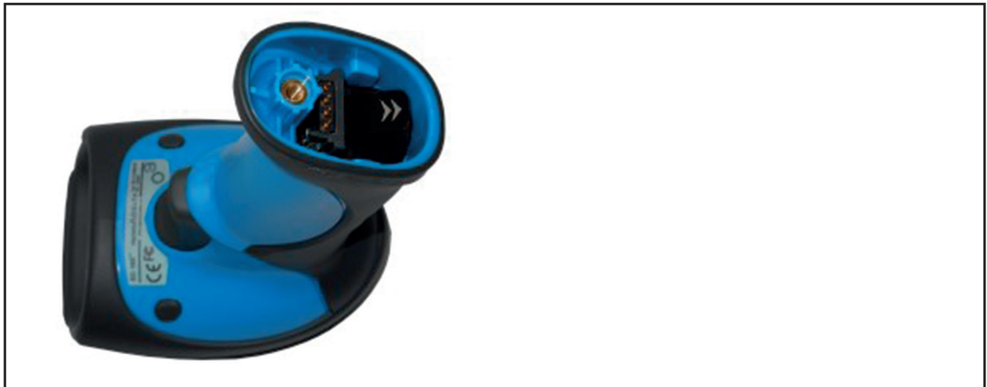
Abbildung 7. Einlegen des Akkus und verschließen der Schutzkappe
