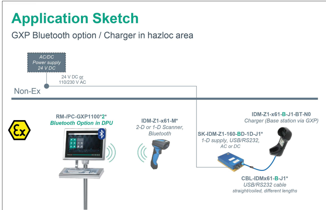
Abbildung 3.3 Systemstruktur 2: Scanner mit Basisstation angeschlossen an VisuNet GXP (Option 1)
