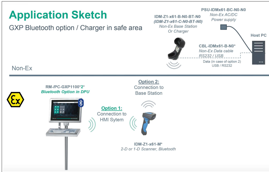
Abbildung 3.5 Systemstruktur 3: Scanner mit Basisstation im sicheren Bereich/Bluetooth-Option VisuNet GXP
