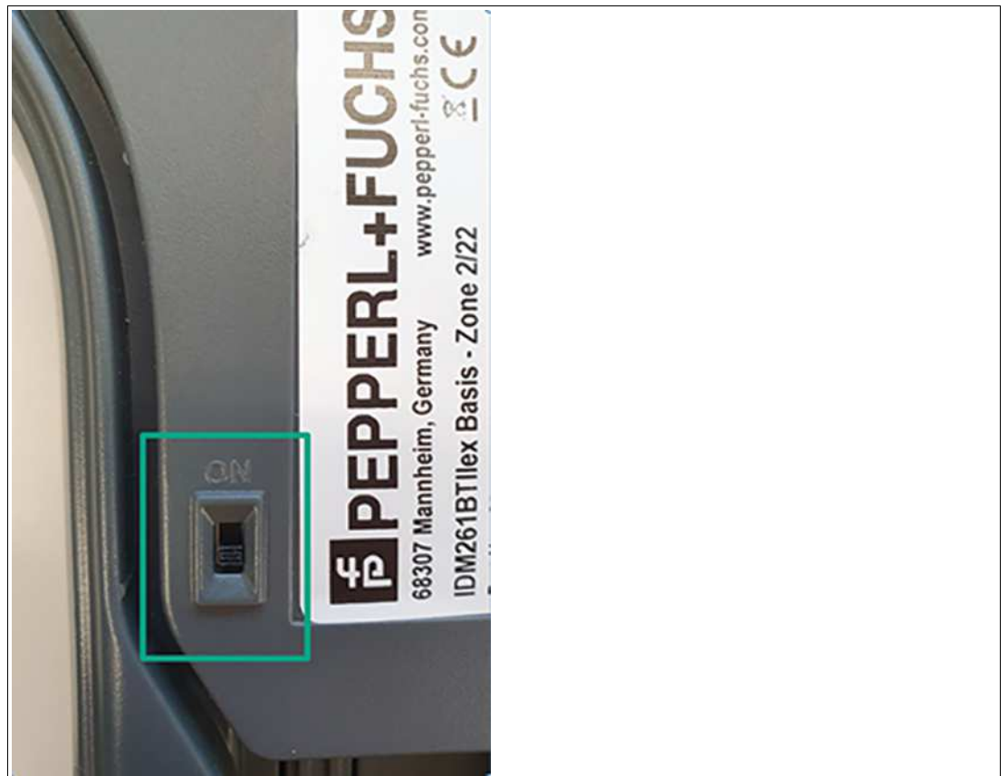
Abbildung 3.7 Wenn USB 3.0 verfügbar ist, stellen Sie den Netzschalter des USB-Busses auf "ON" (EIN). Schließen Sie dann die Ladestation und das Host-Gerät über ein USB-Kabel an.
