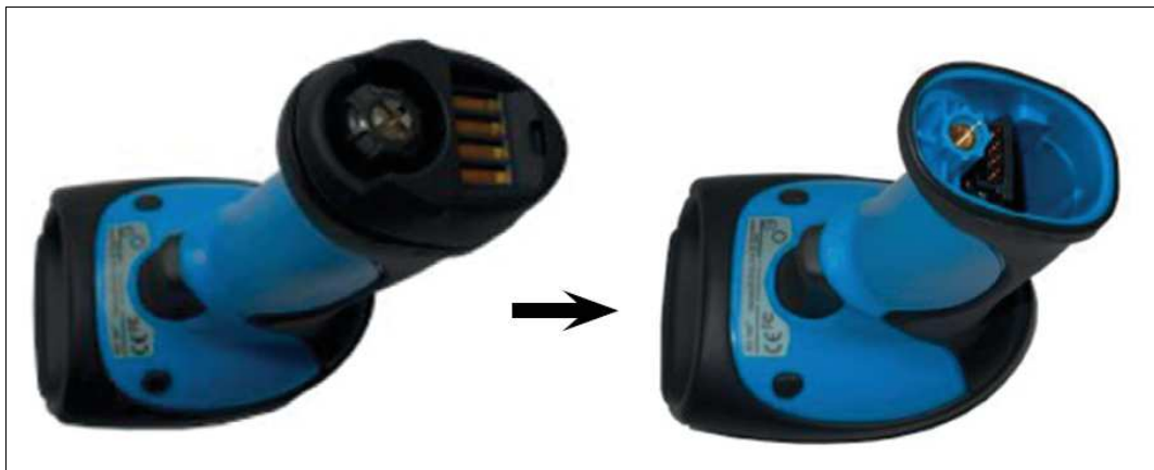
Abbildung 4.1 Entfernen des Batteriefachdeckels
