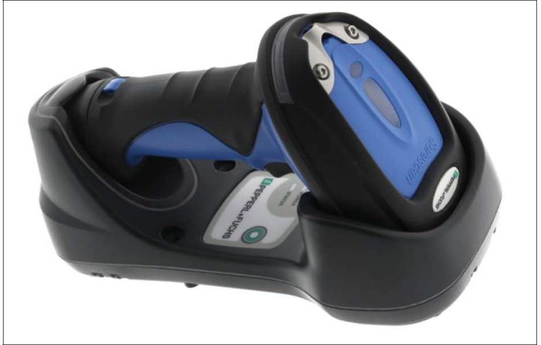
Abbildung 4.11 Einsetzen des Scanners in die Basisstation
