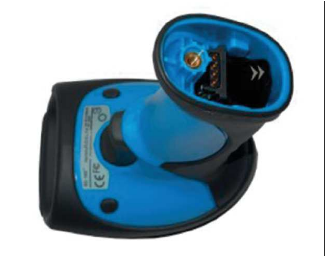
Abbildung 4.3 Einsetzen der Batterie und Schließen der Schutzkappe
