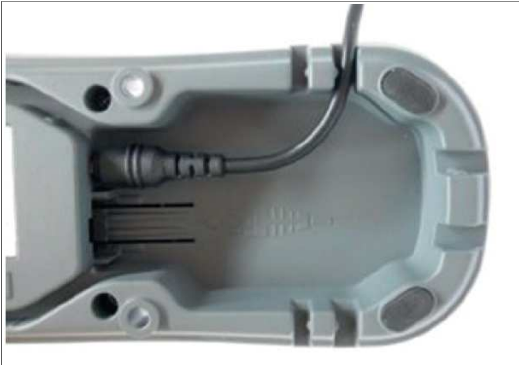
Abbildung 4.9 Anschließen des Netzteils für die Nicht-Ex-Basisstation
