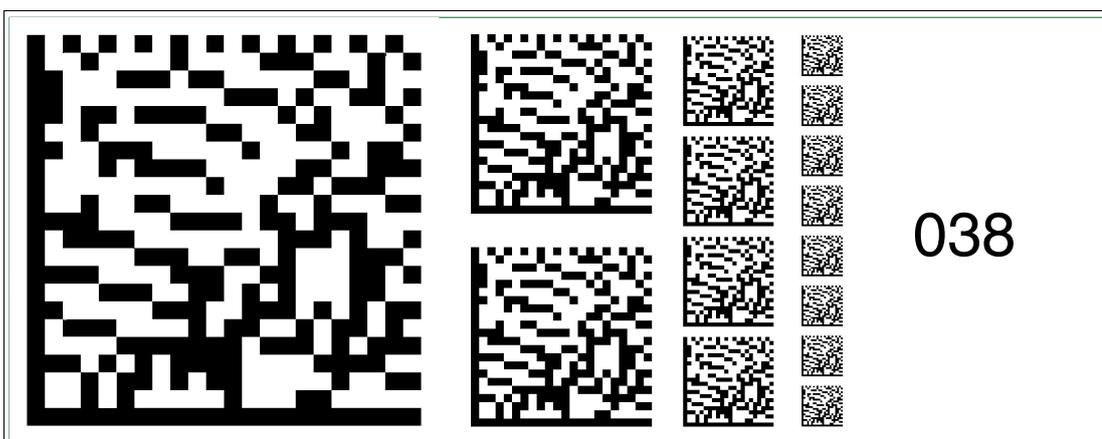
Abbildung 6.54 Die Codekarte "Feldbusadresse 038" weist dem Gerät die Feldbusadresse 038 zu.
