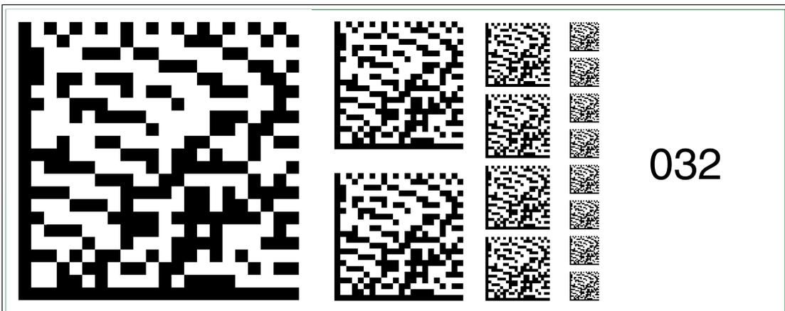
Abbildung 6.48 Die Codekarte "Feldbusadresse 032" weist dem Gerät die Feldbusadresse 032 zu.
