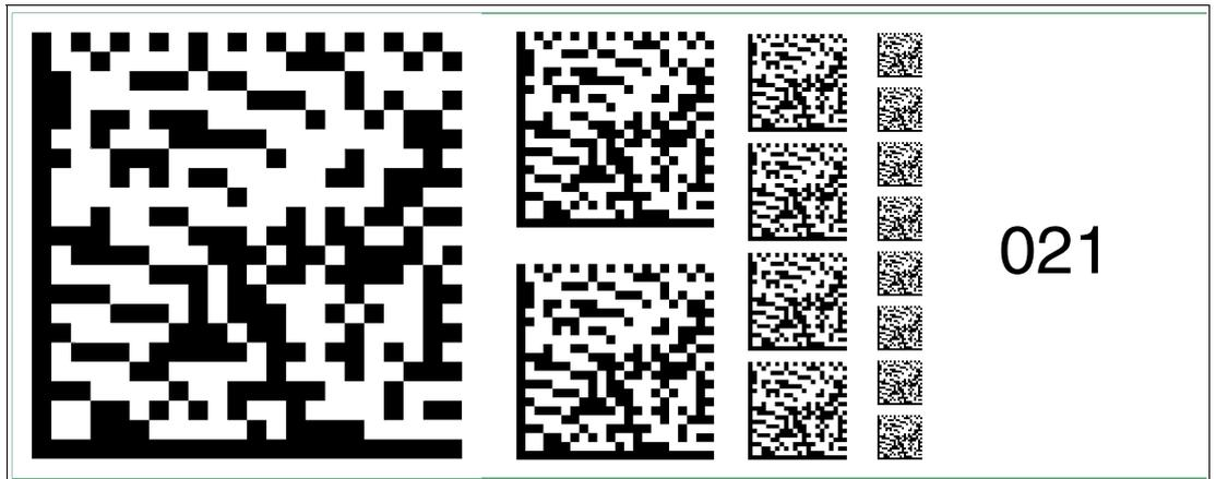
Abbildung 6.37 Die Codekarte "Feldbusadresse 021" weist dem Gerät die Feldbusadresse 021 zu.
