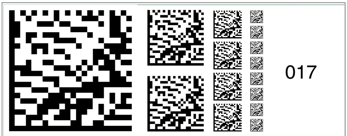
Abbildung 6.33 Die Codekarte "Feldbusadresse 017" weist dem Gerät die Feldbusadresse 017 zu.
