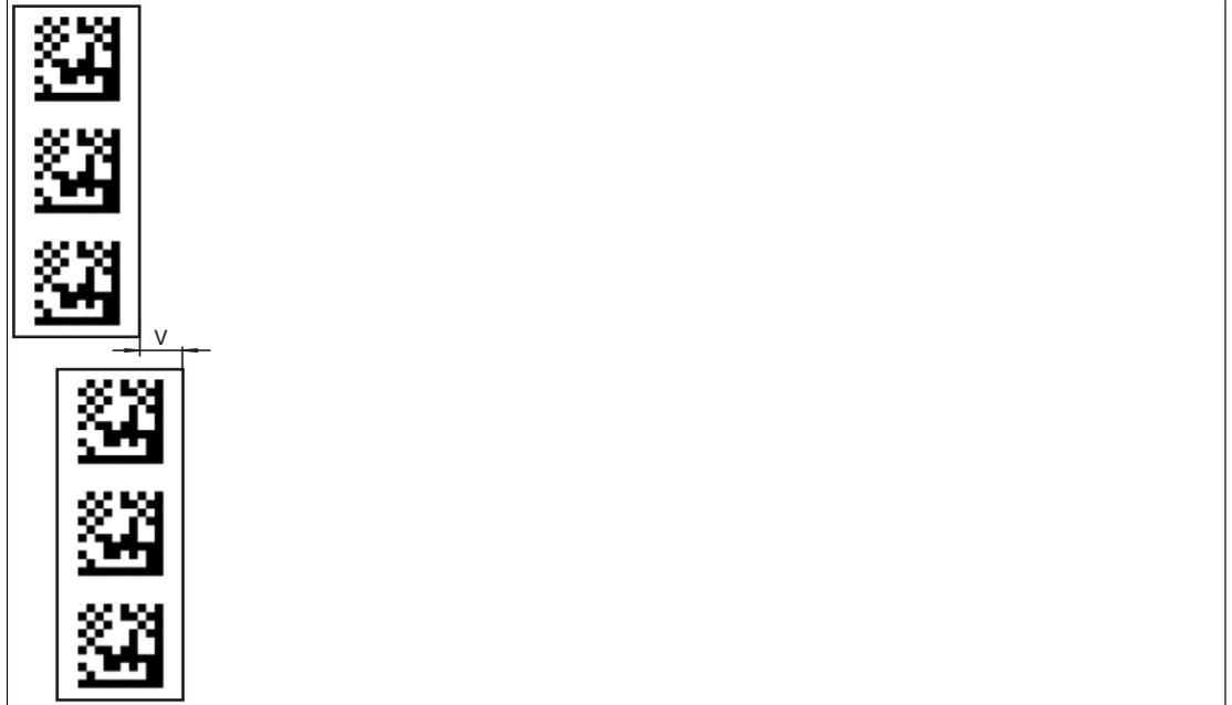
Abbildung 3.8 Versatz:  $0 \text{ mm} \leq V \leq 5 \text{ mm}$
