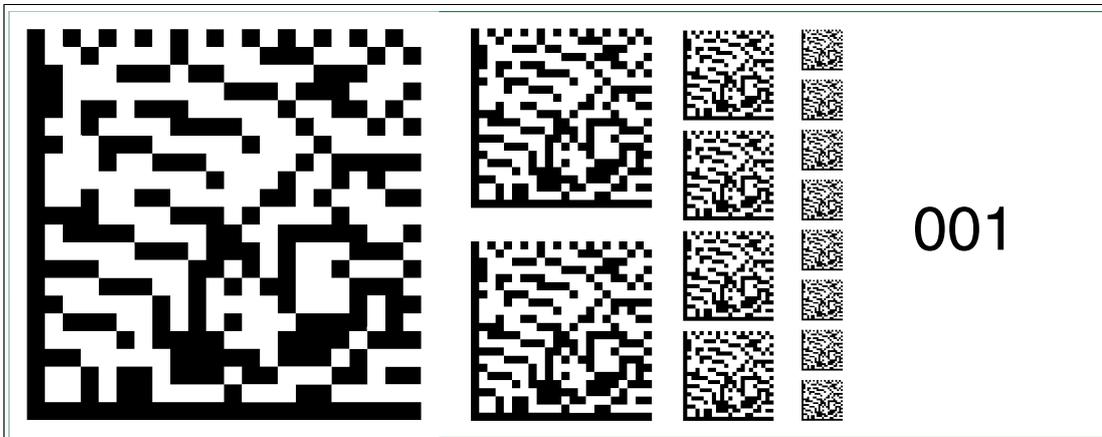
Abbildung 6.17 Die Codekarte "Feldbusadresse 001" weist dem Gerät die Feldbusadresse 001 zu.
