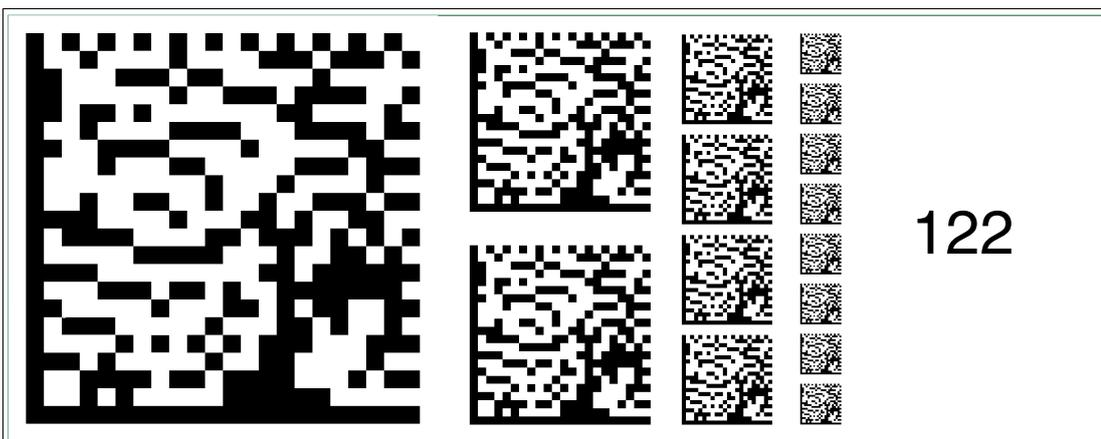
Abbildung 6.138 Die Codekarte "Feldbusadresse 122" weist dem Gerät die Feldbusadresse 122 zu.
