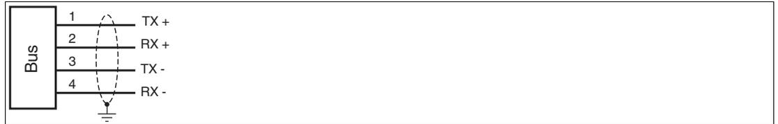
Abbildung 6.13 Anschlussdiagramm PROFINET
