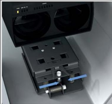
5. Klicken Sie das Gerät in die Aussparungen ein. Vergewissern Sie sich, dass die Haltefüße des Geräts soweit eingerastet sind, dass sie die beiden Riegel bis zum Anschlag nach Außen drücken können. Dazu drücken Sie das Gerät ggf. mit etwas Kraft von oben mittig hinein.
