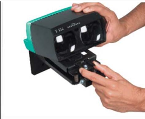
↳ Die Riegel springen bis zum Anschlag zurück nach außen.
