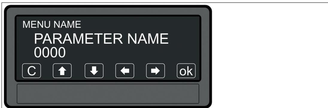
Abbildung 4.3 Über die Pfeiltasten können Sie den gewünschten Parameter auswählen und mit "OK" bestätigen.
