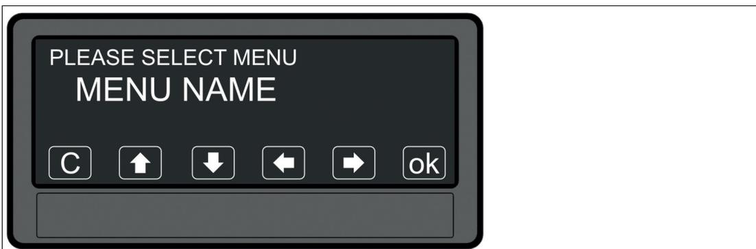
Abbildung 4.2 Über die Pfeiltasten können Sie das gewünschte Parameter-Menü auswählen und mit "OK" bestätigen.
