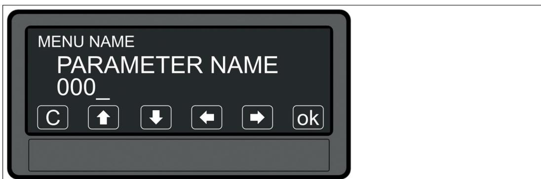
Abbildung 4.4 Über die Pfeiltasten können Sie den ausgewählten Parameter editieren und mit "OK" speichern.
