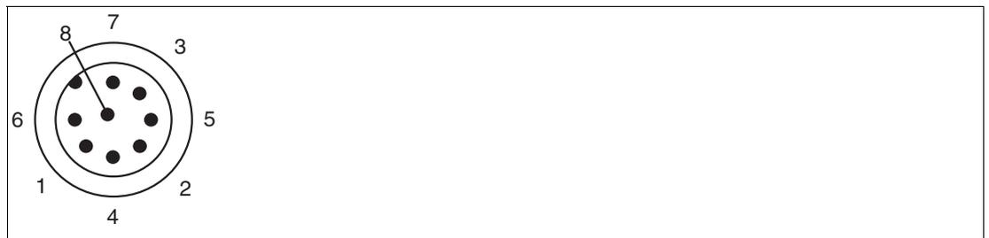
Abbildung 2.7 Pinbelegung Spannungsversorgung
