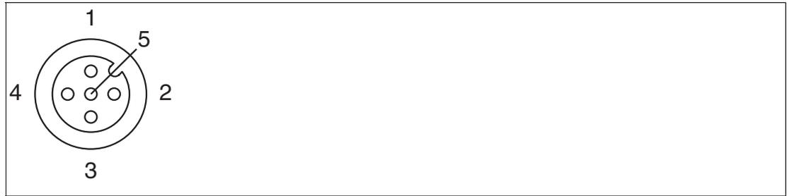
Abbildung 2.6 Pinbelegung Triggeranschluss
