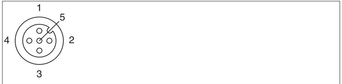
Abbildung 2.6 Pinbelegung Triggeranschluss
