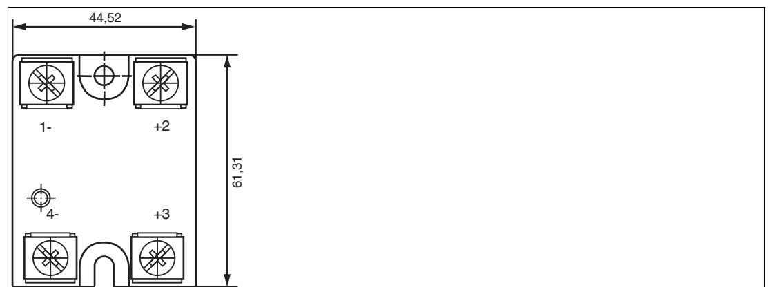
Abbildung 5.8 Abmessung Solid State Relais
