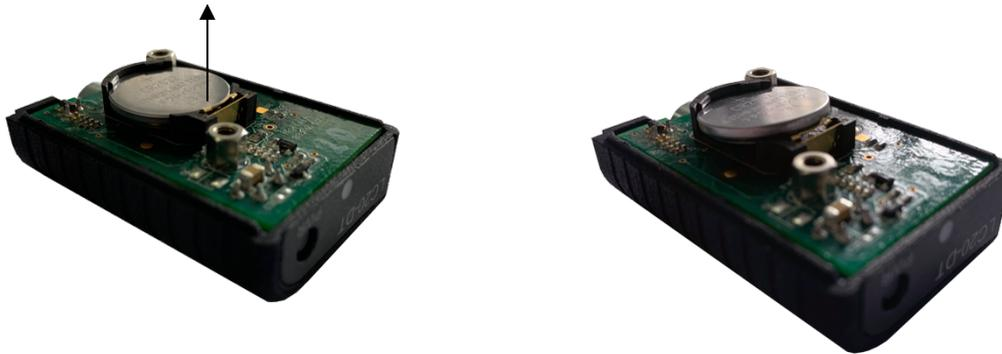
**Bild 2: Entfernen der Batterie**
