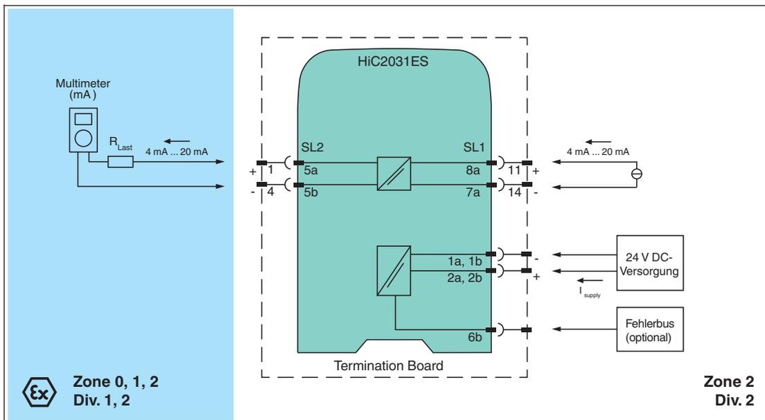
Abbildung 5.2 Aufbau Wiederholungsprüfung für HiC2031ES
