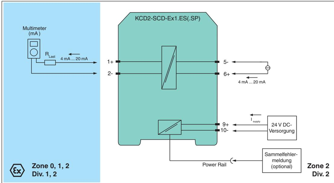
Abbildung 5.1 Aufbau Wiederholungsprüfung für KCD2-SCD-Ex1.ES(.SP)
