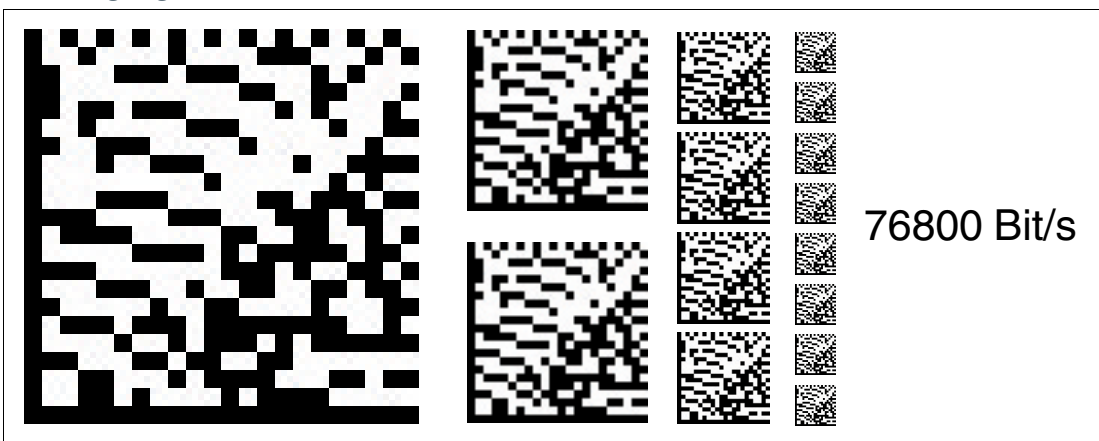
Abbildung 6.14 Die Übertragungsrate des Lesekopfs für die Kommunikation über die Schnittstelle wird auf 76800 Bit/s eingestellt.
