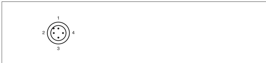
Abbildung 4.3 Anschlussbelegung Spannungsversorgung
