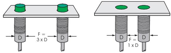
Nicht bündig einbaubarer Näherungsschalter, F muss 3 mal dem Gehäusedurchmesser entsprechen
