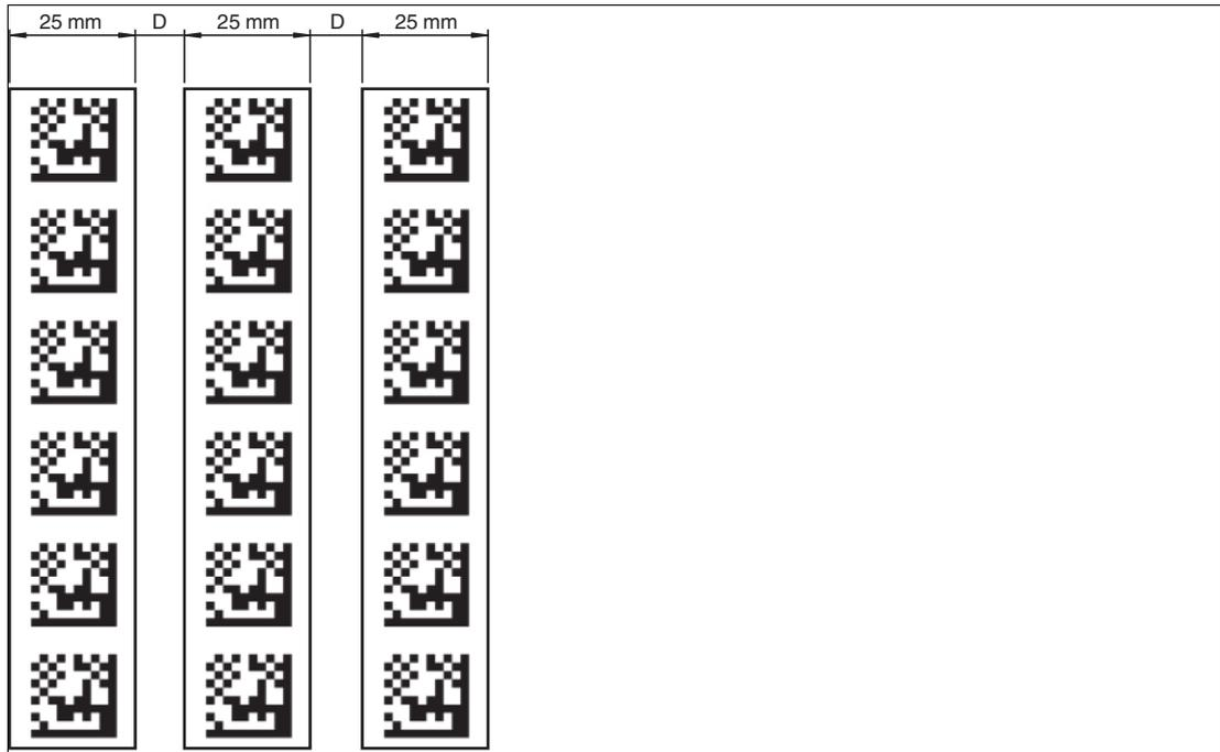
Figure 3.10  $0 \text{ mm} \leq D \leq 5 \text{ mm}$
