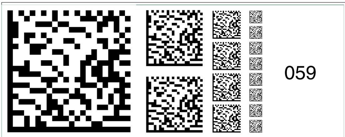
Figure 6.73 Die Codekarte "Feldbusadresse 059" weist dem Gerät die Feldbusadresse 059 zu.
