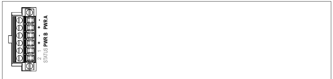
Abbildung 3.6 Steckverbinder mit Schraubklemmen
