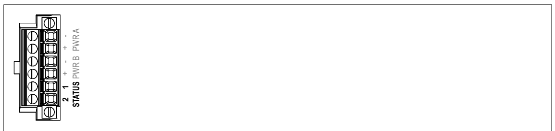
Abbildung 3.8 Steckverbinder mit Schraubklemmen
