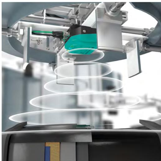
加硫プレスに挿入する前に、緑色のタイヤを明確に識別します。タイヤの混同によるプレスやタイヤの損傷を防ぎます。困難な周囲条件（熱、限られた設置スペースなど）に最適です。
