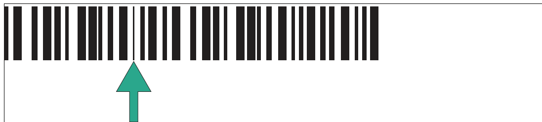
Abbildung 4.4 Modulgröße = minimale Strichbreite
