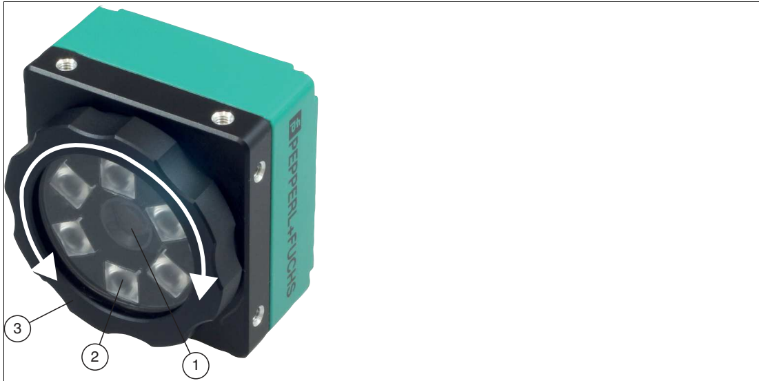
Abbildung 2.1 M12-Objektiv (1), Abdeckung (3) und LED-Ringlicht (1)
