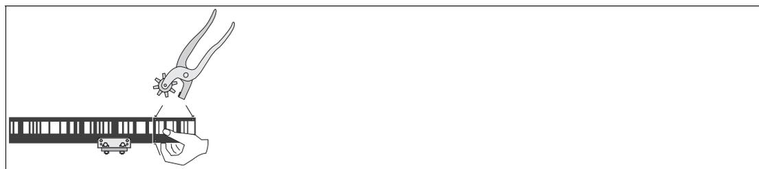
5. Halten Sie die aufeinanderliegenden Codeschienen fest, damit sie nicht verrutschen. Stanzen Sie vier Löcher mit einem Durchmesser von 3 mm, mittels einer Lochzange wie im Bild zu sehen, durch die beiden Codeschienteile.
