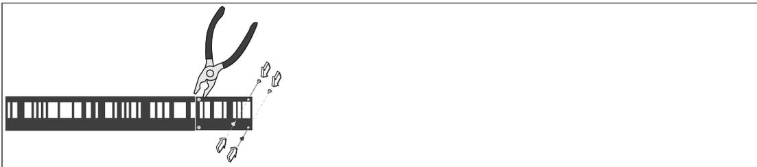
6. Setzen Sie die Hohlknoten aus dem Reparaturset in die Löcher ein, setzen Sie die Gegenstücke auf und drücken Sie mit einer Flach- oder Wasserpumpenzange zusammen.
