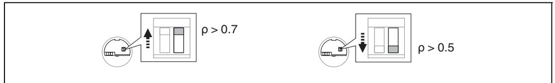
Abbildung 11.3 Schalterstellung auf dem Elektronikeinsatz für Dichte
