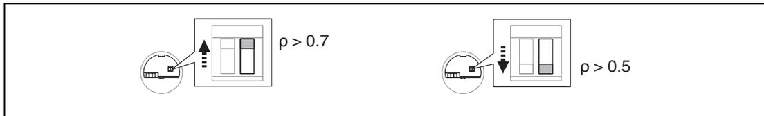
Abbildung 12.3 Schalterstellung auf dem Elektronikeinsatz für Dichte
