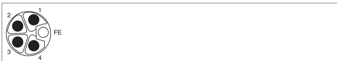
Abbildung 3.4 Schemazeichnung M12 L-Codierung (Stecker); Port X03 (IN)
