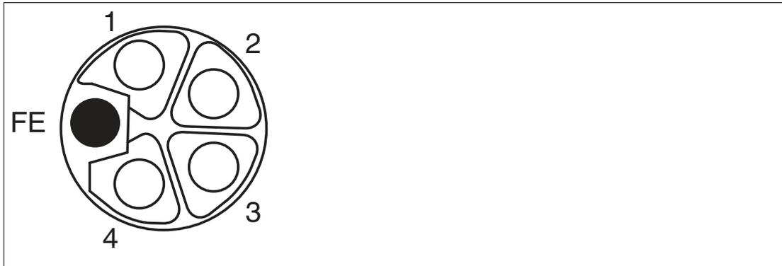
Abbildung 3.5 Schemazeichnung M12 L-Codierung (Buchse); Port X04 (OUT)
