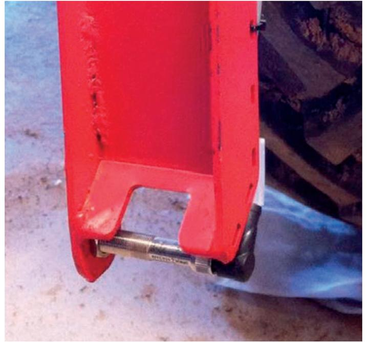
An jeder Radaufhängung ist ein Ultraschallsensor montiert, der den Abstand zwischen den Rädern und dem Erdbeerfeld kontinuierlich überwacht.
