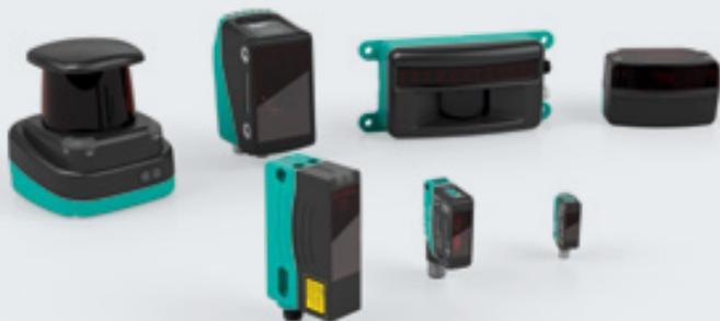
Messende optoelektronische Sensoren sind für anspruchsvollere Anwendungen geeignet als rein optoelektronische Sensoren, die nur die Ab- oder Anwesenheit eines Objekts erkennen. Sie ermitteln nicht nur das Vorhandensein eines Objekts, sondern per MPT (Multipixel Technology) oder PRT (Pulse Ranging Technology) auch dessen Position oder Entfernung.
