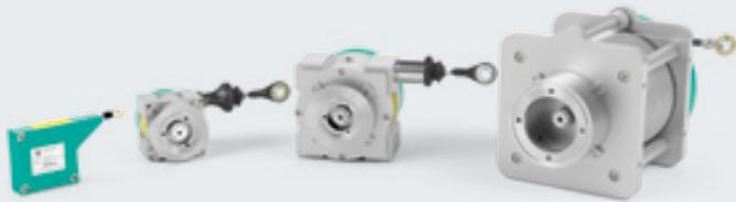
Seilzug-Drehgeber eignen sich hervorragend zur Erfassung linearer Bewegungsabläufe, indem ein Stahlseil und eine federgespannte Trommel mit einem geeigneten Inkremental- oder Absolutwert-Drehgeber kombiniert werden.
