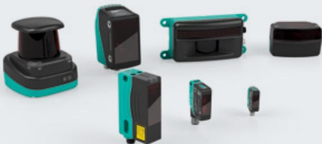
I sensori fotoelettrici di distanza sono adatti per applicazioni più impegnative rispetto ai sensori fotoelettrici che rilevano solo la presenza o l'assenza di un oggetto. Grazie alla tecnologia MPT (Multipixel Technology) o PRT (Pulse Ranging Technology), determinano la posizione o la distanza di un oggetto, oltre che la presenza.
