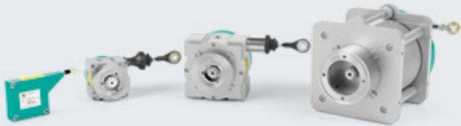
Gli avvolgitori a filo consentono agli encoder di misurare il movimento lineare utilizzando un cavo d'acciaio e un tamburo a molla in combinazione con un appropriato encoder rotativo incrementale o assoluto.
