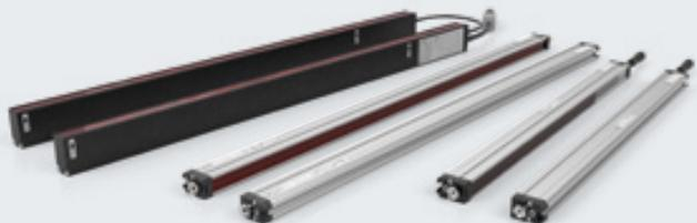
Le barriere optoelettroniche sono costituite da un trasmettitore e da un ricevitore con una serie di raggi infrarossi. Il campo di rilevamento bidimensionale viene utilizzato per il monitoraggio di grandi aree nel settore dell'imballaggio, nei magazzini e nella movimentazione dei materiali.
