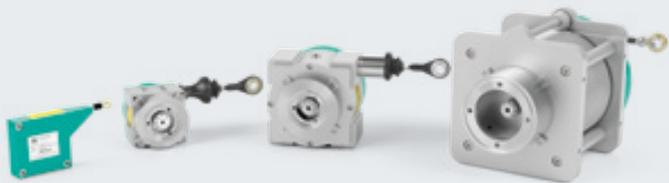
Los tiradores de cable permiten a los encoders medir el movimiento lineal con un cable de acero y un tambor cargado por resorte junto con un encoder incremental o giratorio absoluto adecuado.
