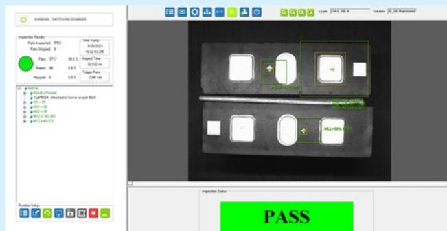
Prüfung der Batteriezellen-Ausrichtung
