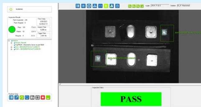
Identifikation der Batteriezelle per DataMatrix-Code
