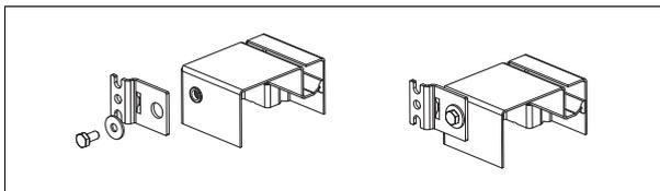
1. Verschrauben Sie die Laschen mit den Löchern in der Gehäuserückwand
