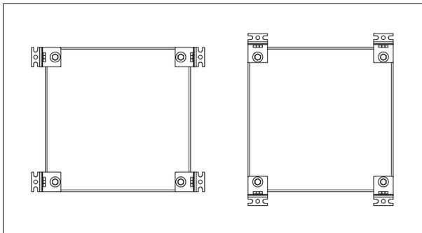
Die Gehäuse können mit separaten Befestigungslaschen oder direkt durch die Gewindenieten in der Rückwand des Gehäuses montiert werden.
